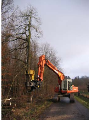
Kontrollierte Fällung und Ablage mit Kettenbagger PowerCut
