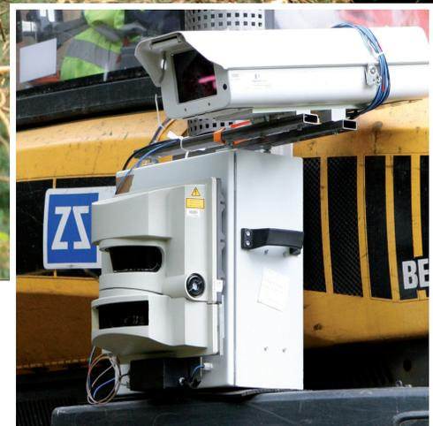
Abb. 1: Sensorsystem am Ponsse Beaver montiert
